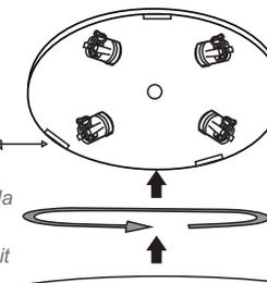
Encaixe a peça e gire-a para fixação.
