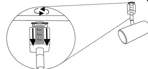
Para instalar o spot, deslize para baixo a parte que está destacada em cinza no desenho, encaixe na calha e gire o spot para fixá-lo.
