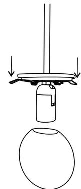
Para remover o vidro, incline a parte metálica para um lado, isso flexionará a haste metálica no interior da esfera e permitirá a remoção do vidro.
